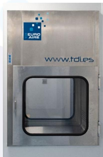
Unidad SAS de paso de materiales de zona sucia a zona limpia y viceversa. La Serie SAS **Ventilados**, además llevan incorporada filtración forzada HEPA para mantener la presión de aire estéril en su interior, evitando contaminaciones cruzadas con zonas sucia o limpia. Con un número de recirculaciones superior a 1,000 /h
